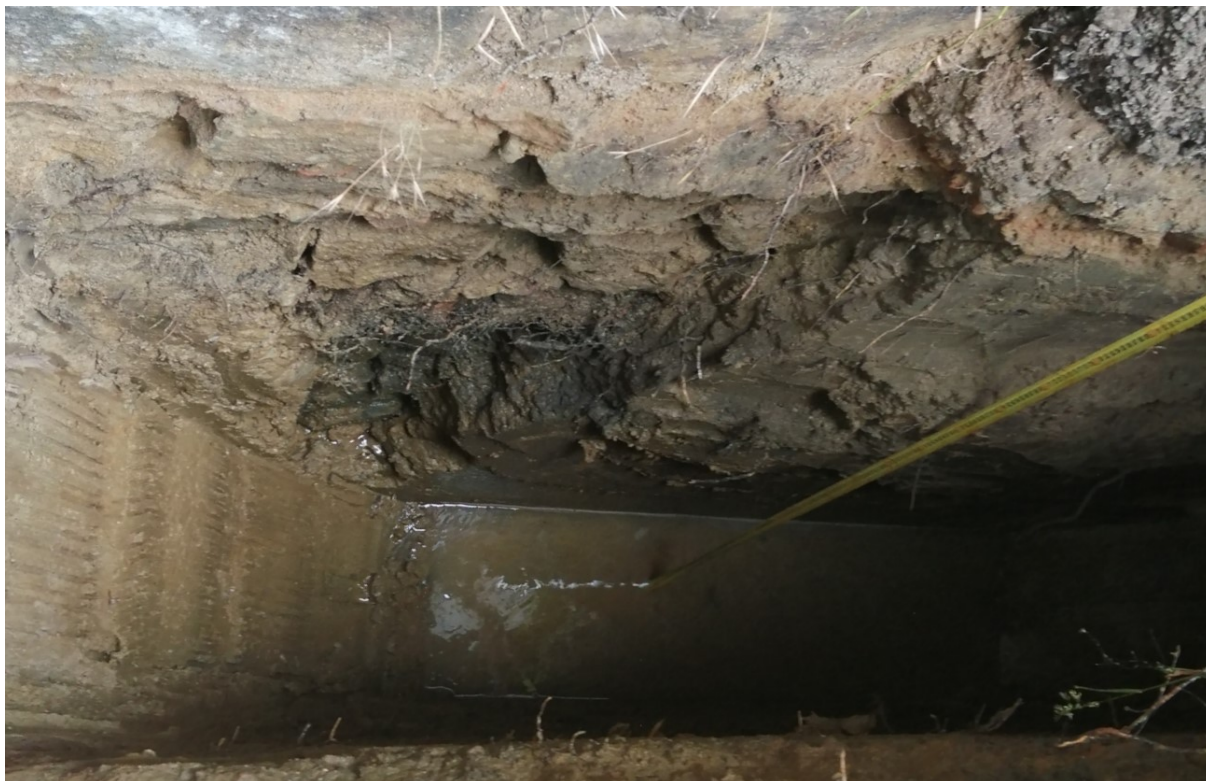
Obrázek č. 3 Kopaná sonda KS32B u západní obvodové stěny objektu
